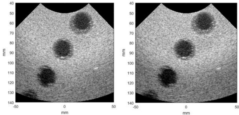
Figura 7. Imágenes del *phantom* de quistes obtenidas aplicando el algoritmo PA con los métodos DAS (izda.) y MPS (dcha.) con foco fijo en emisión situado en 100mm. (60dBs).
