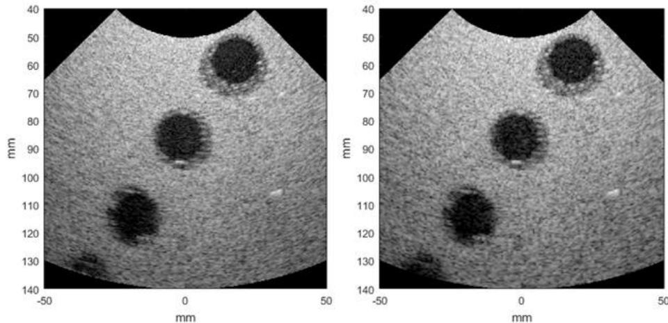
Figura 4. Imágenes del *phantom* de quistes obtenidas aplicando el algoritmo TFM con los métodos DAS (izda.) y MPS (dcha.) (60dBs).
