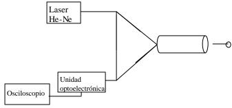
en la dirección simétrica de la incidente se mezcla posteriormente con el otro haz, de una frecuencia ligeramente menor. La señal resultante se demodula en fase para obtener una señal proporcional a la componente normal del desplazamiento del punto de incidencia, que se registra en un osciloscopio digital. La FFT de la señal muestra unos máximos coincidentes con las frecuencias naturales de
