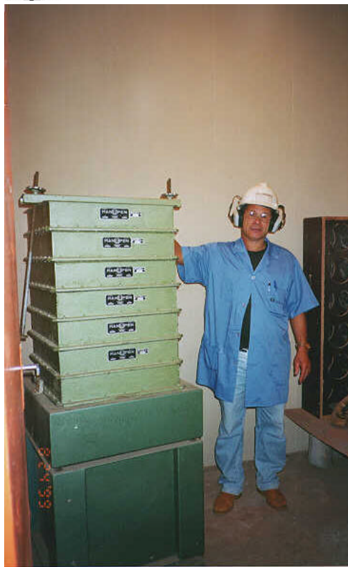
Figura 2 – Vista do interior da sala de peneiras com a série de peneiras para determinação de granulometria de agregado graúdo e o funcionário operador
