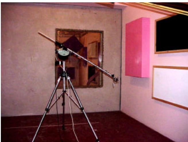
Cámara de transmisión horizontal del Laboratorio de Control De Calidad de la edificación del Gobierno Vasco
