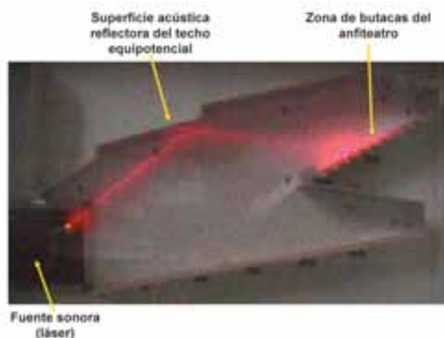
Figura 12. Simulación del funcionamiento acústico del techo equipotencial de un teatro a través del SAGEA 01. Foto del autor.
