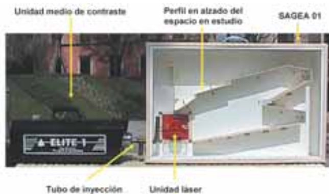
Figura 11. Partes esenciales del SAGEA 01. Foto del autor.
