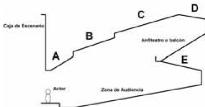
Figura 01. Los reflectores A, B, C, D y E constituyen el techo acústico equipotencial de este teatro.
