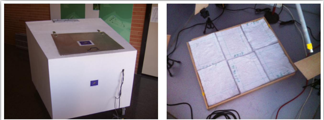
Figura 5. Imagen de la cámara reverberante a escala diseñada para este proyecto y de un ensayo de absorción en ésta.
